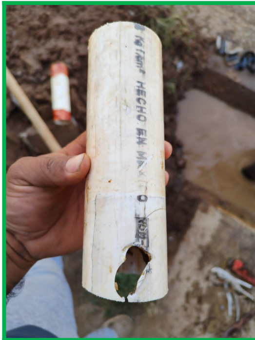
REPARACIÓN DE FUGA EN TUBERÍA DE 2" EN AV. JORGE PASQUEL ZONA CENTRO
